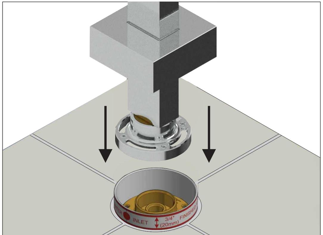
Vertical levelling / Nivelación vertical
