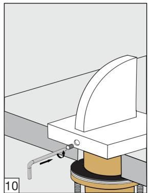
Handle installation/ Instalación del volante
